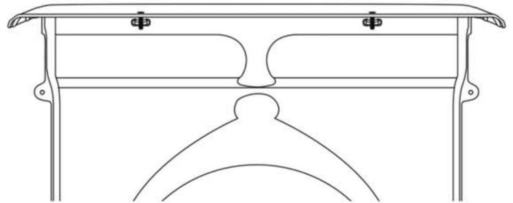
Установите 2 крепежные С-скобы в пазы на камине. Поместите полку на камин и вставьте два болта М8 в отверстия на полке таким образом, чтобы они проходили через крепежные выступы (рис.3) и С-скобы с обратной стороны камина. Для затягивания следует использовать плоскую отвертку.
